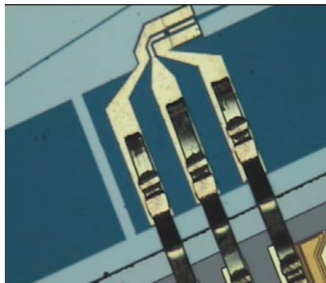
Bovenaanzicht van goudbandjes die verbindingen vormen tussen twee chips. Onder zijn drie geplaste oppervlakken te zien. Foto: Barry Smalbrugge
